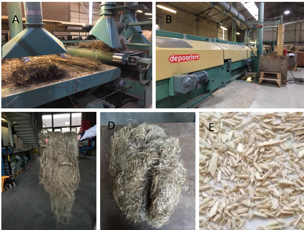
Figuur 2.13. Brakelen (A), zwingellijn (B), lange vezel (C), 'klodden' (D) en 'scheven' (E).
