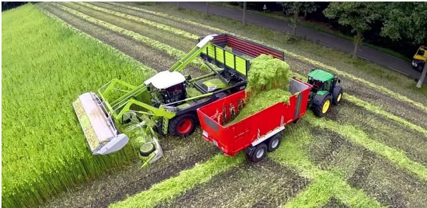
Figuur 2.10. Vezelhennep oogsten met een aangepaste Claas Xerion 4000 VC van DunAgro uit Oud-Pekela. Deze maaï- strippercombinatie scheidt het eiwit rijke loof van de stengel en laat de verhakselde vezelrijke stengel achter op het land.
