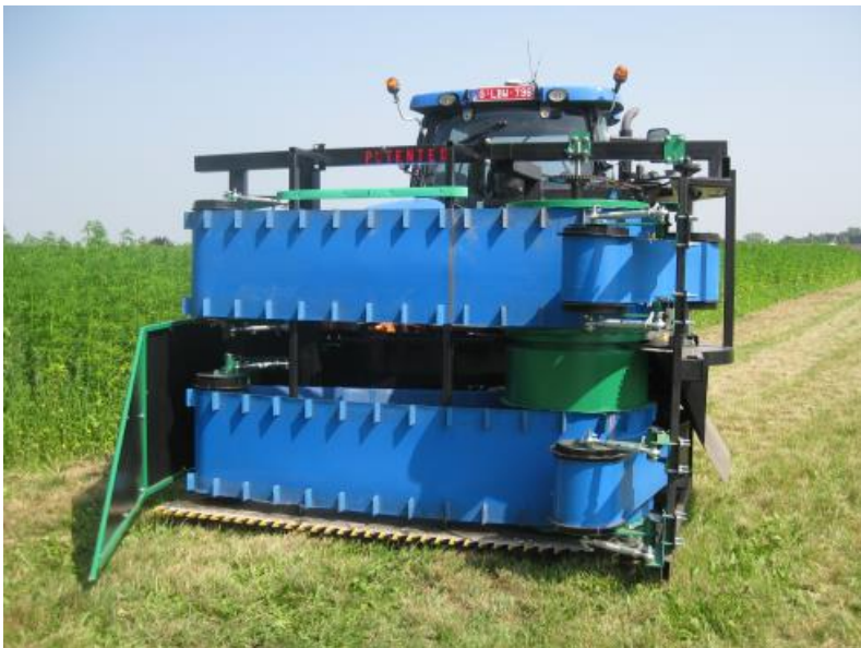
Figuur 2.11. Prototype oogstmodule hennep voor lange vezeldoeleinden, ontwikkeld door de firma Hemplnvest (getoond op 26-06-2019 te Bottelare – werking niet gedemonstreerd).
