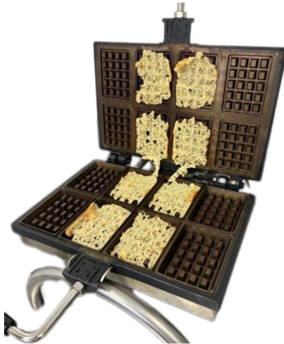
Figuur. Een hoge dosis rijsmiddel verminderde bij volledige eivervanging met B8 de integriteit van de wafel, waardoor deze bij het openen van het ijzer in een boven- en onderhelft uiteenviel.
