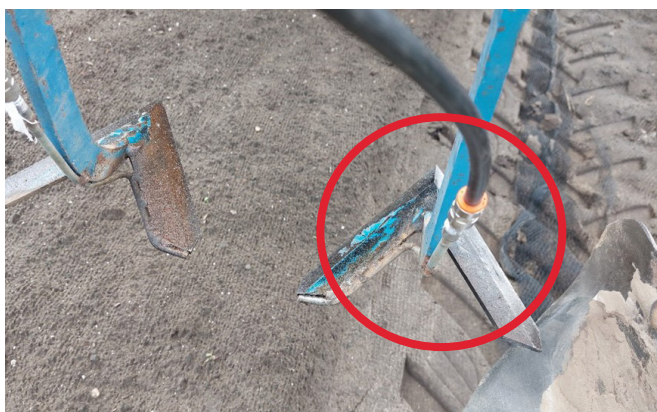
Figuur 2: Aansluiting van de persluchtsslagen op de schoffelelementen, waarop buisjes gelast werden.
